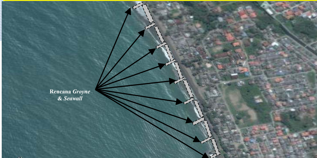
Gambar 7.3 Rencana Pembangunan Pengamanan Pantai (GROYNE & SEAWALL)
